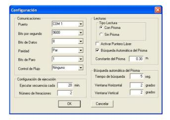
Para cada estación total puede programarse la realización de una intersección inversa automática cada cierto tiempo. Para otros dispositivos se establecen asimismo intervalos para su alineación.
