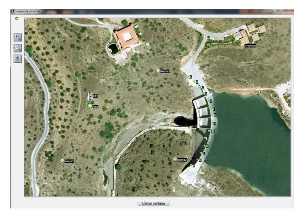
Asimismo pueden definirse secuencias de observación de puntos, especificando las horas de inicio y finalización, el intervalo de entre medidas, el número de repeticiones para cada lectura, etc. Un mismo punto puede ser observado por varios dispositivos. Con estos datos el funcionamiento puede ser totalmente automático, dejando el ordenador en modo desatendido.
